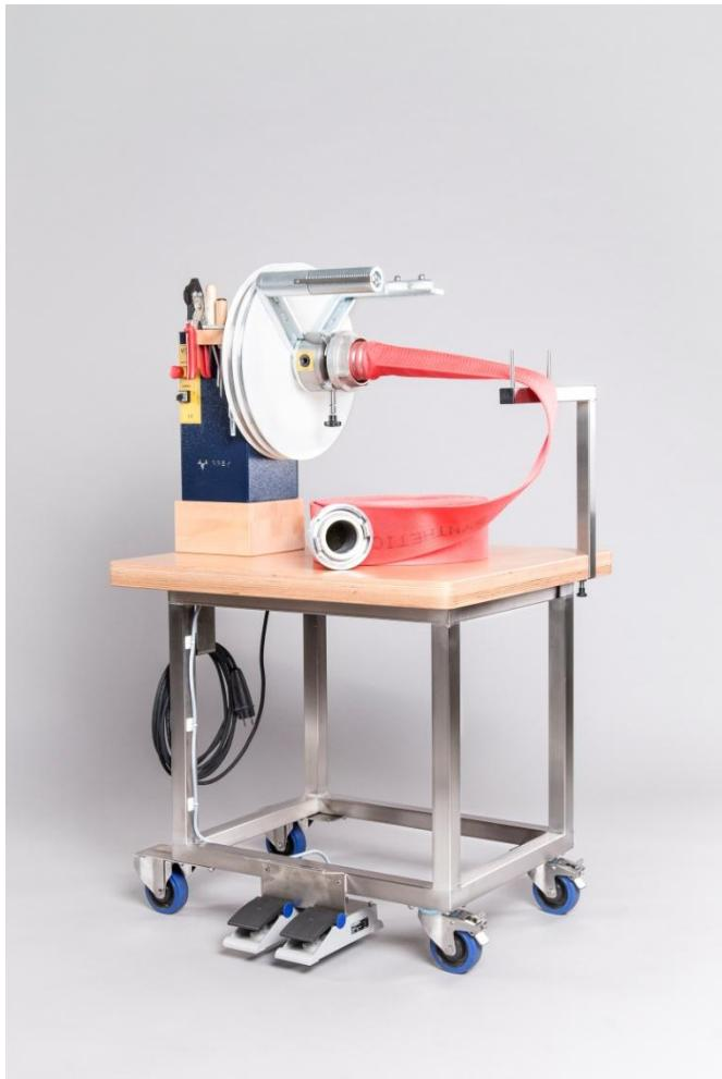
Das ORIGINAL !!! Keine kann es ähnlich verlässlich, sicher oder genauso gut, geschweige denn besser. Die SEM ist die erste Schlauchkupplungseinbindemaschine mit ruhendem Schlauch, die den Draht um den Kupplungshals wickelt und nicht den Schlauch nebst Kupplung in den Draht dreht und dabei spiralförmig verdreht.
