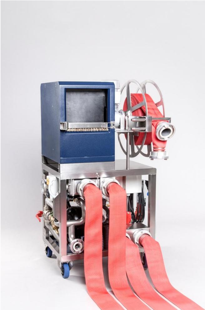
Drei Funktionen in einem Gerät für die Wäsche und Druckprüfung von bis zu zwei Feuerwehrdruckschläuchen der Größen B, C und D gleichzeitig bzw. einem der Größe A und einem automatischen Schlauchwickler für Schlauchlängen bis 35 m - optional auch als Mammut-Variante für F-Schläuche und Schlauchlängen bis 40 m.
