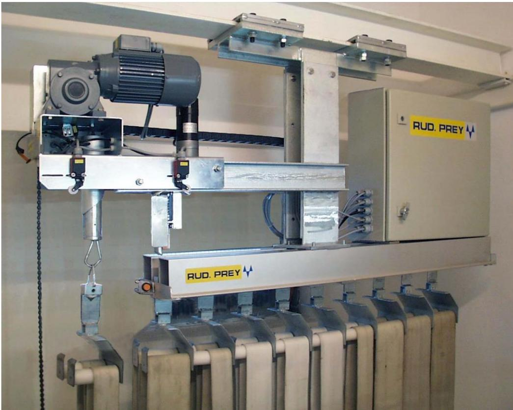
**Die kleinste unter den automatischen Schlauch-Aufhängeanlagen mit nur einer Bahn für Gerätehäuser freiwilliger und Werkfeuerwehren mit kleinen Schlauchpfeletürmen.**
