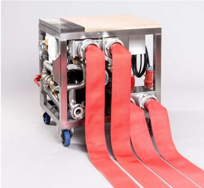
den mobilen Wicklern für die gleichzeitige Druckprüfung von bis zu zwei Feuerwehrdruckschläuchen der Größen B, C und D gleichzeitig bzw. je einem der Größen A und F mit integrierten Prüfendverschlüssen.
