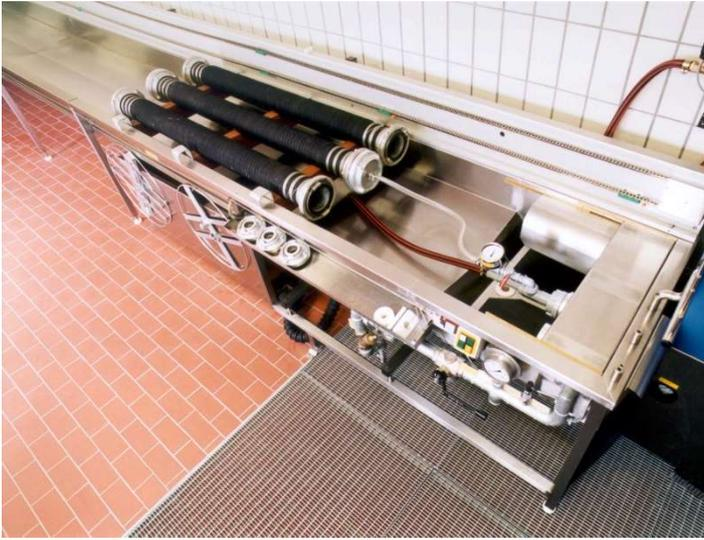
**Die separate Saugschlauch-Prüf-Einrichtung zum Prüfen von Saugschläuchen gemäß DIN 14810 auf Druck, Vakuum und innere Beschaffenheit, speziell für die Anwendung in Schlauchpflegeanlagen von PREY.**
