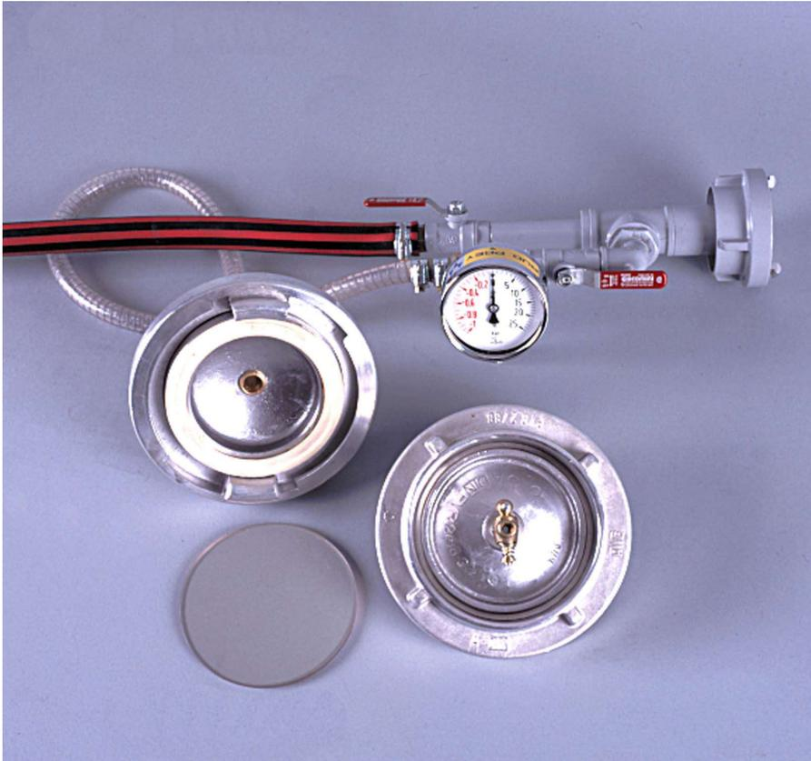
**Die separate Saugschlauch-Prüf-Einrichtung zum Prüfen von Saugschläuchen gemäß DIN 14810 auf Druck, Vakuum und innere Beschaffenheit.**
