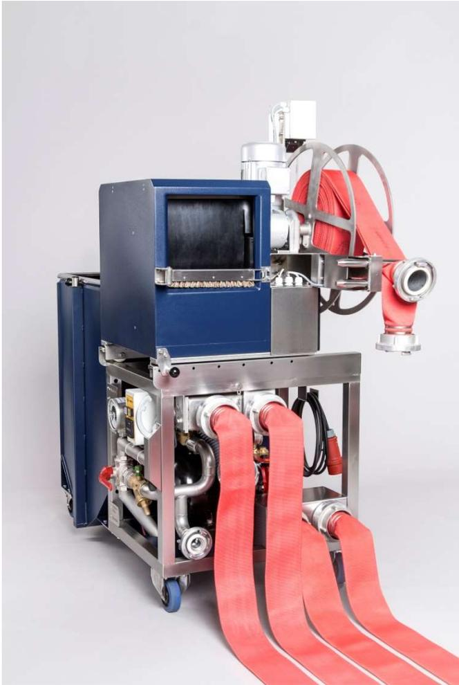
**Vier Funktionen in einem Gerät mit integriertem großen Vorweichbehälter für die Wäsche und Druckprüfung von bis zu zwei Feuerwehrdruckschläuchen der Größen B, C und D gleichzeitig bzw. einem der Größe A und einem automatischen Schlauchwickler für Schlauchlängen bis 35 m - optional auch als Mammut-Variante für F-Schläuche und Schlauchlängen bis 40 m.**
