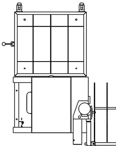
SWM verschiebbar für optimale Nutzung des KVA
