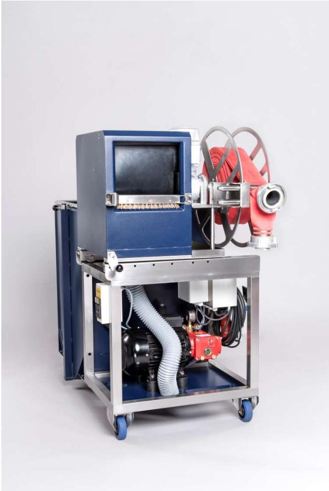
Drei Funktionen in einem Gerät mit integriertem großen Vorweichbehälter für die Wäsche von bis zu zwei Feuerwehrdruckschläuchen der Größen B, C und D gleichzeitig bzw. einem der Größe A und einem elektrischen Schlauchwickler für Schlauchlängen bis 35 m - optional auch als Mammut-Variante für F-Schläuche und Schlauchlängen bis 40 m.
