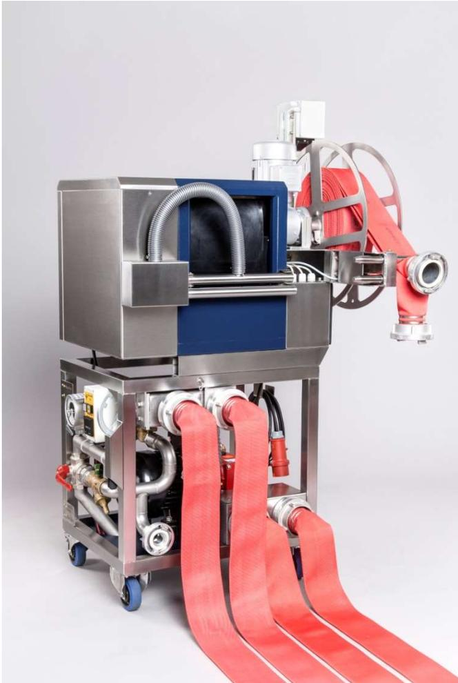
**Vier Funktionen in einem Gerät für die Wäsche, Trocknung und Druckprüfung von bis zu zwei Feuerwehrdruckschläuchen der Größen B, C und D gleichzeitig bzw. einem der Größe A und einem automatischen Schlauchwickler für Schlauchlängen bis 35 m - optional auch als Mammut-Variante für F-Schläuche und Schlauchlängen bis 40 m.**
